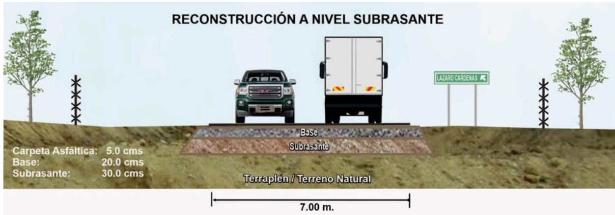
Figura 21. Reconstrucción a Nivel Subrasante
