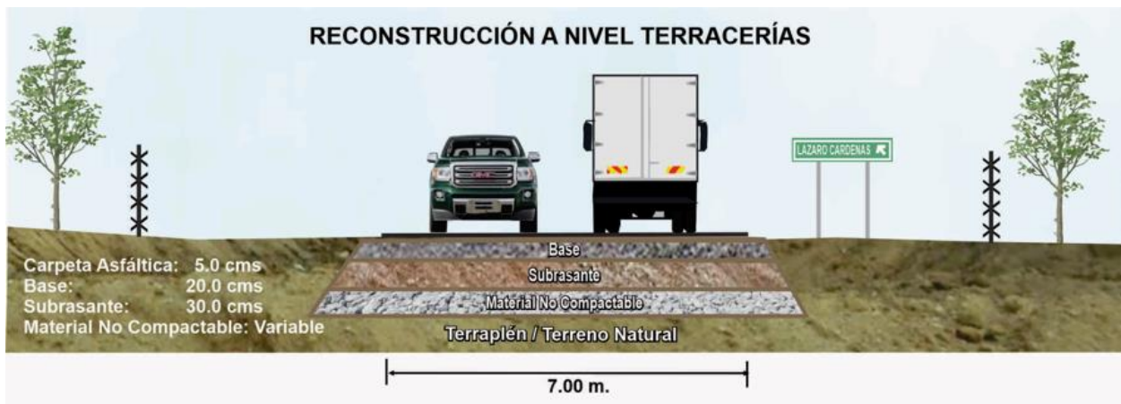
Figura 20. Reconstrucción a Nivel Terracerías
