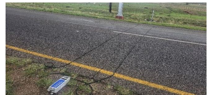
IMG. 62. Colocación e instalación de equipos de aforo automáticos en tramo Km 5.0 (Cuauhtémoc – Tomochi – Carichi).
