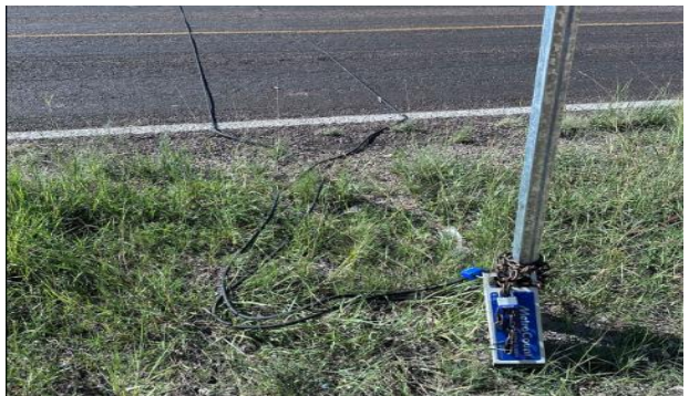
IMG. 66. Colocación e instalación de equipos de aforo automáticos en tramo C. San Francisco de Borja – Nonoava
