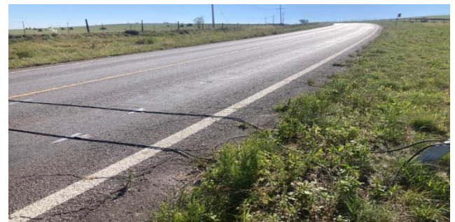
IMG. 56. Colocación e instalación de equipos de aforo automáticos en tramo C. La Casita – Balleza.
