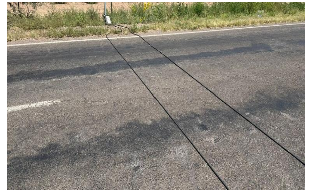
IMG. 56. Colocación e instalación de equipos de aforo automáticos en tramo C. La Casita – Balleza.
