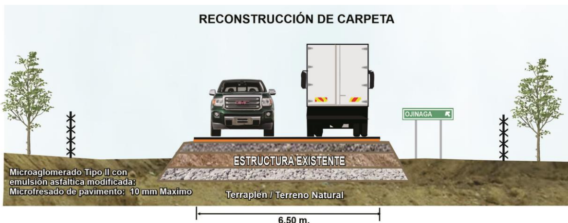
Figura No. 10. Sección Tipo de los trabajos de Reconstrucción (Fuente: Elaboración propia)
