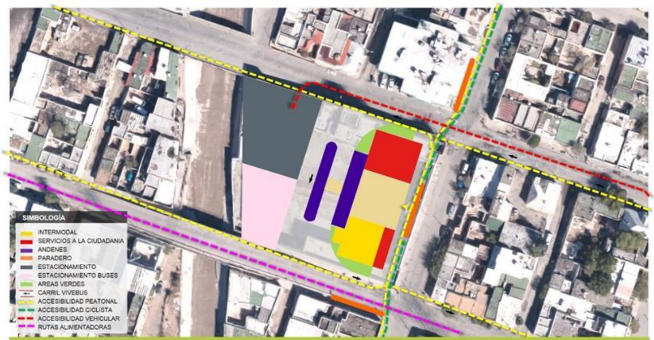
- Figura 5-21 Dimensionamiento y ubicación de estación intermodal Oro
