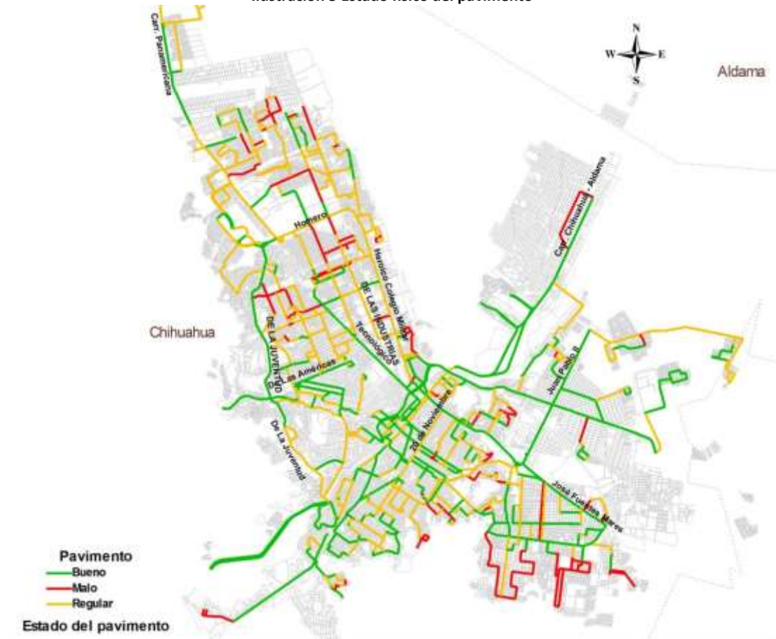
Ilustración 5 Estado físico del pavimento
