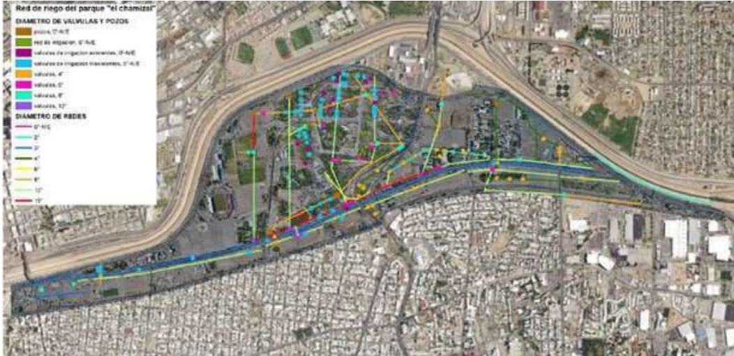
Ilustración 25 Red de riego y válvulas del parque El Chamizal
