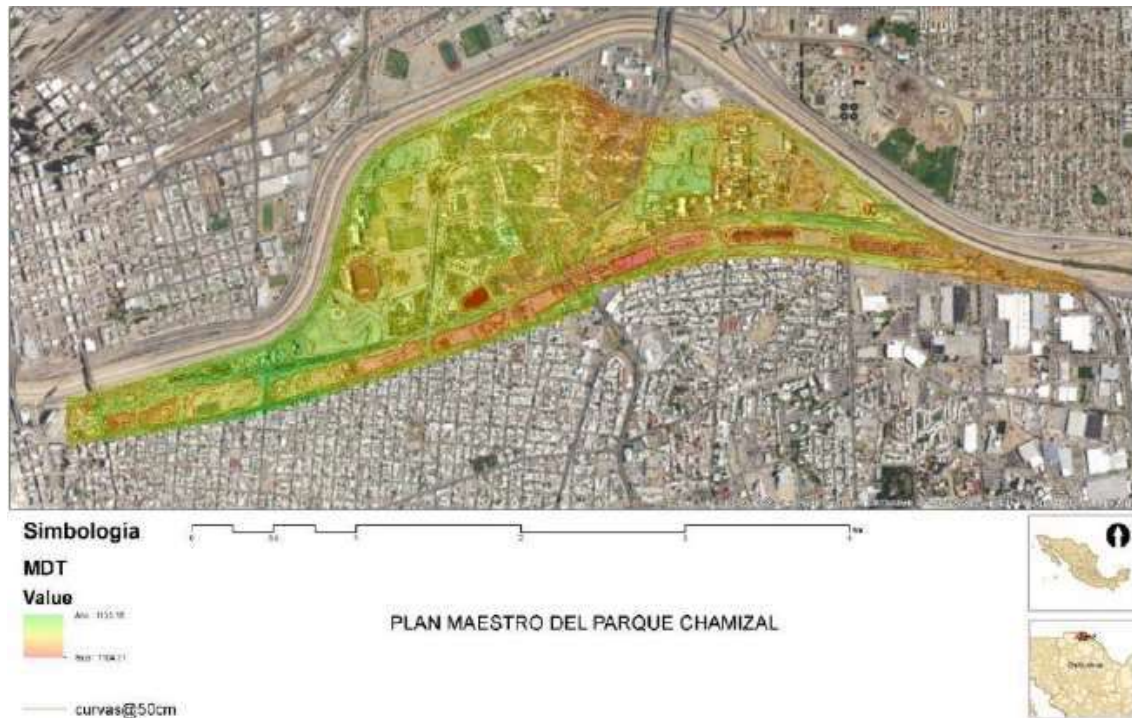
Ilustración 105 Modelo de elevación con base a curvas de nivel
