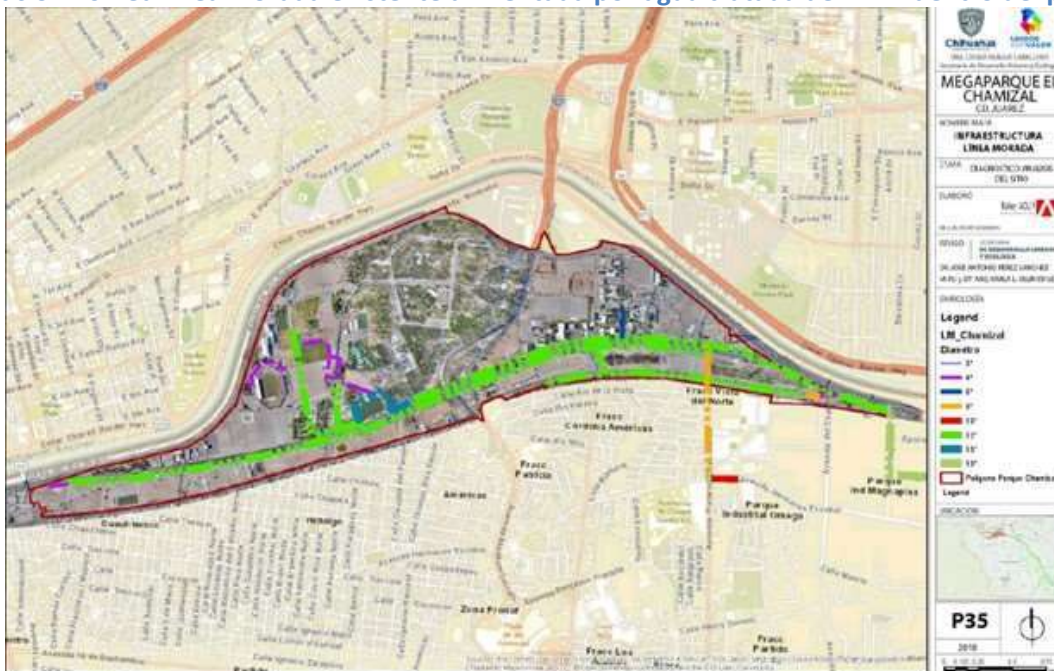
Ilustración 26 Red línea morada existente alimentada por agua tratada de PTAR dentro del parque
